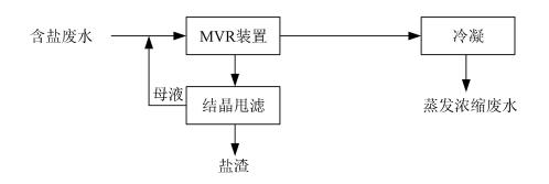
图 4.1.2-3 MVR 装置处理工艺
