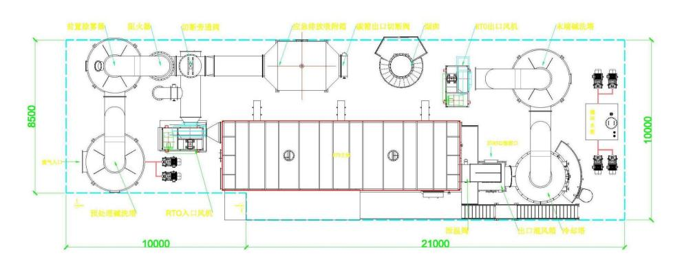
图 4.2.2-1 1#废气焚烧装置处理处理流程
