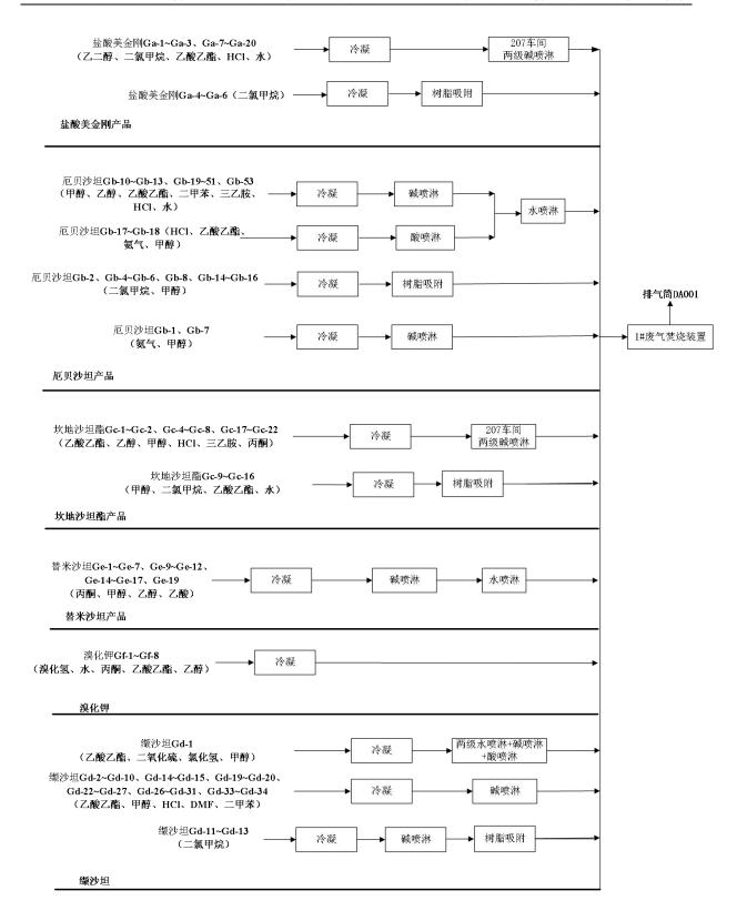
图 4.2.2-3 本项目废气处理措施示意图 (2)
