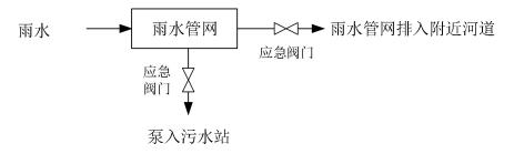
图 4.1.2-1 厂区初期雨水、事故废水收集系统示意图
