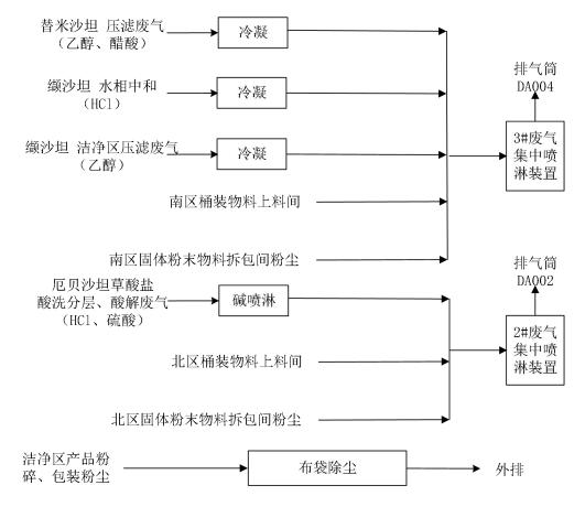
图 4.2.2-2 本项目废气处理措施示意图 (1)
